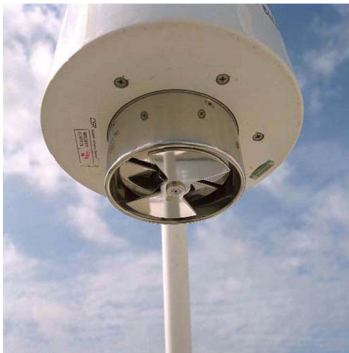
Particolare del « mulino » di un E-Field Mill
